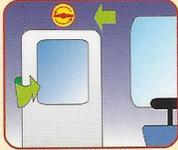
An den Ausstiegstüren befinden sich deutlich sichtbare Nothähne. Bei Gefahr sind diese in Pfeilrichtung zu drehen. Die Tür lässt sich danach manuell aufstoßen. Falls Ihnen dies nicht allein gelingt, bitten Sie Mitreisende um Hilfe. Auch Dachluken können als Notausstiege genutzt werden.
